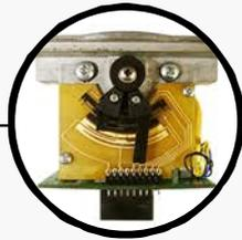
ALTO DESGASTE EN PISTAS DE CARBÓN Y ESCOBILLAS
